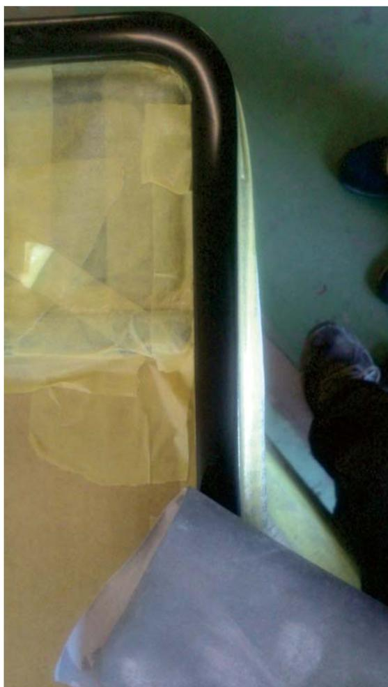
③ #800ペーパーでヤスリをした部分を整え、凸凹が無いように研磨する。修理部分だけでなく塗装する場所には#800ペーパーをする。
